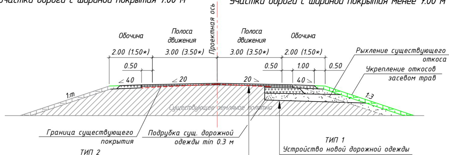
Верхний слой покрытия с одновременным выравниванием из асфальтобетона плотного из горячей мелкозернистой щебеночной смеси, тип Б, марка II, ГОСТ 9128-2013, на битуме марки БНД-100/130 по ГОСТ 33133-2014, толщиной слоя 0,07 м + (переменной толщины)
